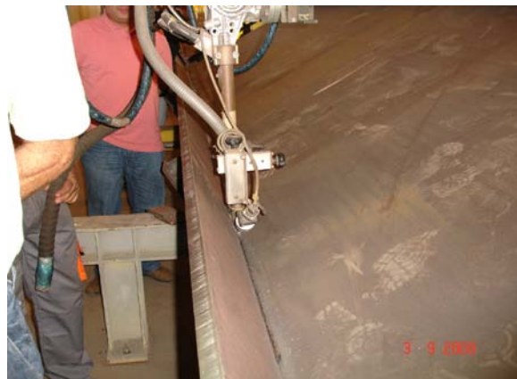
Φωτ. 4 Συγκόλληση Κάτω πέλματος δοκού με S.A.W.
